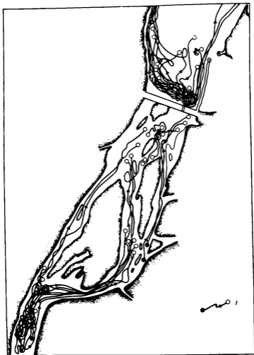
Рис. 9. Пути движения осетров (1) в верхнем и нижнем бьефах Волжской ГЭС имени XXII съезда КПСС
